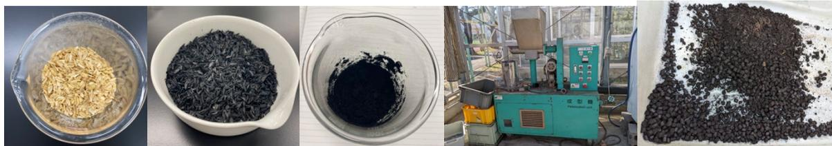
左から籾殻、リン酸賦活籾殻燻炭、アンモニア吸着リン酸賦活籾殻燻炭、ペレタイザー、ペレット化した籾殻燻炭試作品
