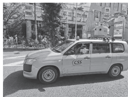
図 2 Mobile Mapping System (Pegasus:Two)
