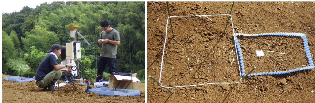
写真 2-1 土壌水分センサと雨量計および集水柵の設置、土壌試料採取（傾斜改善効果検証）
