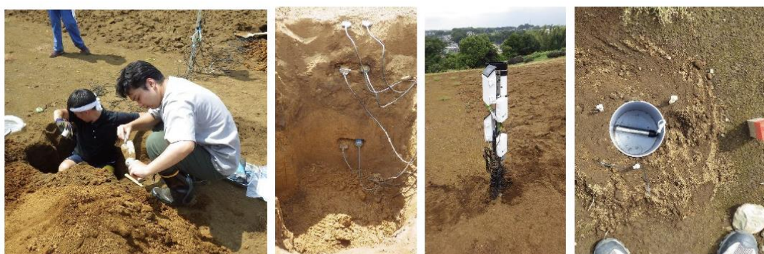
写真 2-3 土壌試料採取、土壌水分センサと雨量計および集水柵の設置（硬盤破碎効果検証）
