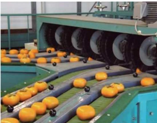
おけさ柿選果場であるJA佐渡おけさ柿共同選果場は、上写真のように柿をベルトコンベアで選果機までコンテナのまま運ばれます。運ばれてきた柿はコンテナから出し、人と機械によって一次選別され、中に混入されている傷の大きい柿や病虫害を受けた柿を除去します。その後、大型自動選果機にかけられた柿は、カメラや重量計のデータに基づいてサイズ別に分けられます。梱包機によってダンボール箱に詰められ、全国の取引市場へ出荷され、小売店で販売されます。
